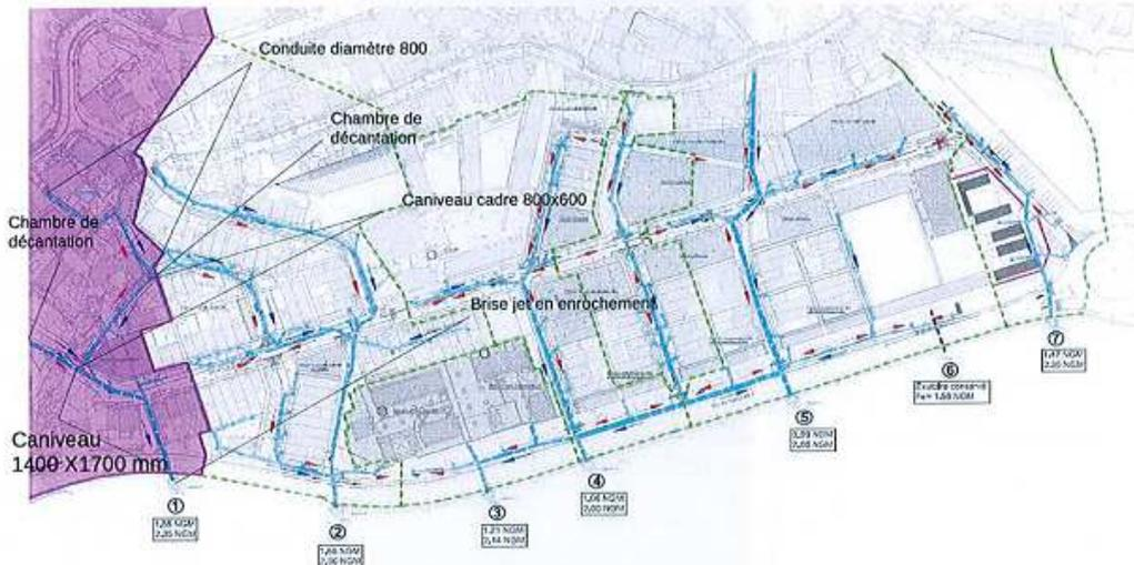
L'exutoire 1 existant sera redimensionné. Il sera constitué d'un caniveau de dimensions 1400x1700mm.
